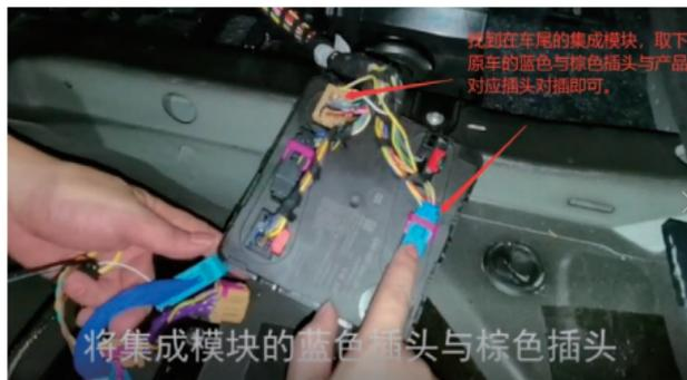
**8** 在集成模块中蓝色插头上找到黑色插头，取出后找到第10号针脚，用镊子取出，并与产品学习插头对插即可；产品的线束插头全部安装完成，学习成功后，将相关线进行隐藏后，并将拆除的对应盖板恢复安装即全部完成；产品线束从尾箱向前端布置时建议从汽车左侧门脚踏脚内原主线束同时布置。
